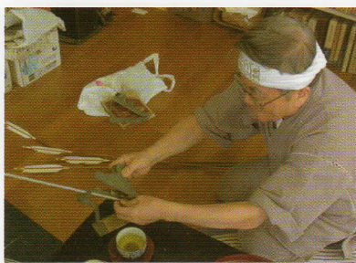
世界大会出場に向けて、研究を重ねたジュラルミン矢と竹矢の数々。中央の羽の小さいものが90メートル用のもの。上の方の矢に取り付けられたプラ羽はフレッチャーという器具で宮田氏自ら装着した手製のもの（左写真）。風の抵抗の具合、角度など詳細に試行を重ねた（第三章参照）。
